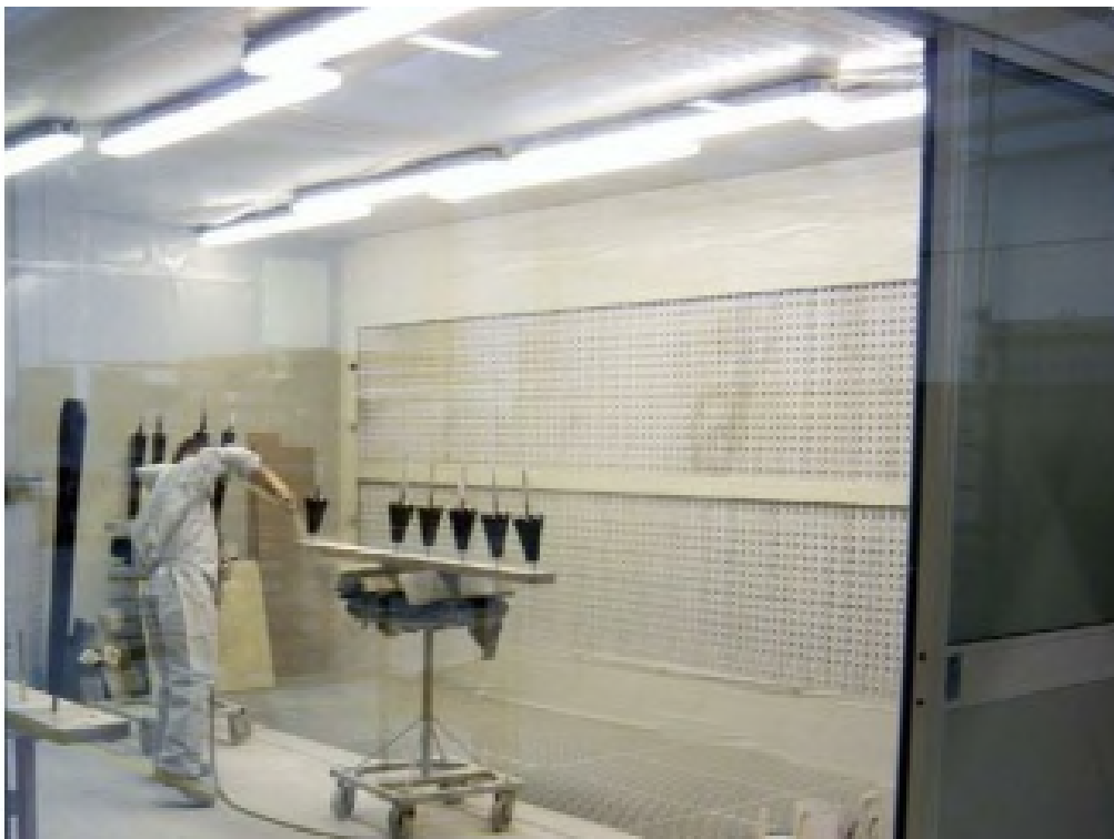
Intérieur de la cabine d'application
